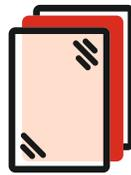
VSG steht für Verbundsicherheitsglas: Zwei oder mehr Flachglasscheiben werden durch eine reißfeste und zäh-elastische Folie verbunden.
